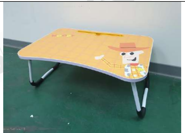
照片 D：測試樣品 - 收樣日期: 2020 年 07 月 29 日 測試靜態荷重 (25 kg)
